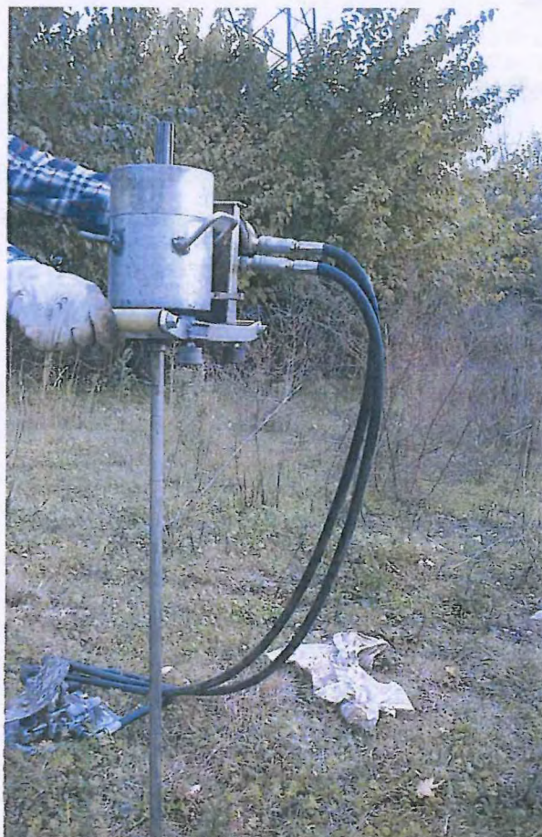
Figura 5 – Penetrometro Dinamico Medio durante l'esecuzione della prova PDM 3
